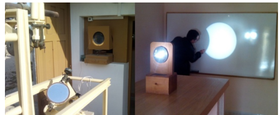
Fig. 27. Imatge del Celòstat de l'OE utilitzats per projectar la imatge del Sol per activitats de divulgació. Imagen del Celóstat del OE utilizado para proyectar la imagen del Sol para actividades de divulgación.
