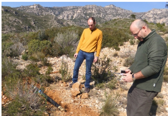
Fig. 10. Imatge d'una de les bobines d'inducció per a les mesures d'alta freqüència de camp magnètic pel sondeig magneto-tel·lúric al voltant de la subestació de Vandellòs. Imagen de una de las bobinas de inducción para las medidas de alta frecuencia de campo magnético para el sondeo magneto-telúrico alrededor de la subestación de Vandellòs.
